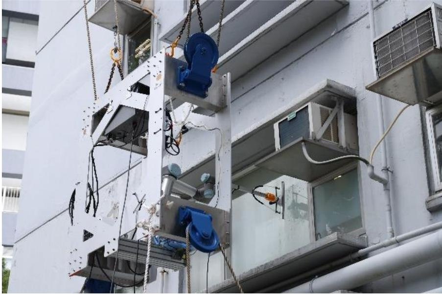
圖三：線控機械人系統能模仿工人在大廈外牆以雨刮抹窗及控制滾筒塗漆，有望代工人於外牆進行玻璃清潔及塗漆等高空工作，以配合建造業的需要。圖為抹窗示範。
